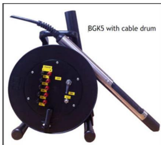
Fig. 6 Geofono da foro BGK5 per prove fino a 50 m
