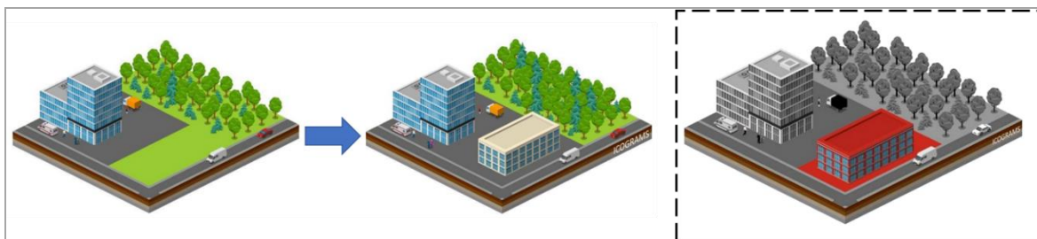
Figura 27- Esempio, secondo la Norma (nel caso di una trasformazione di suolo per costruzione edilizia) del calcolo delle superfici rispetto alle quali commisurare l'invarianza idraulica.
