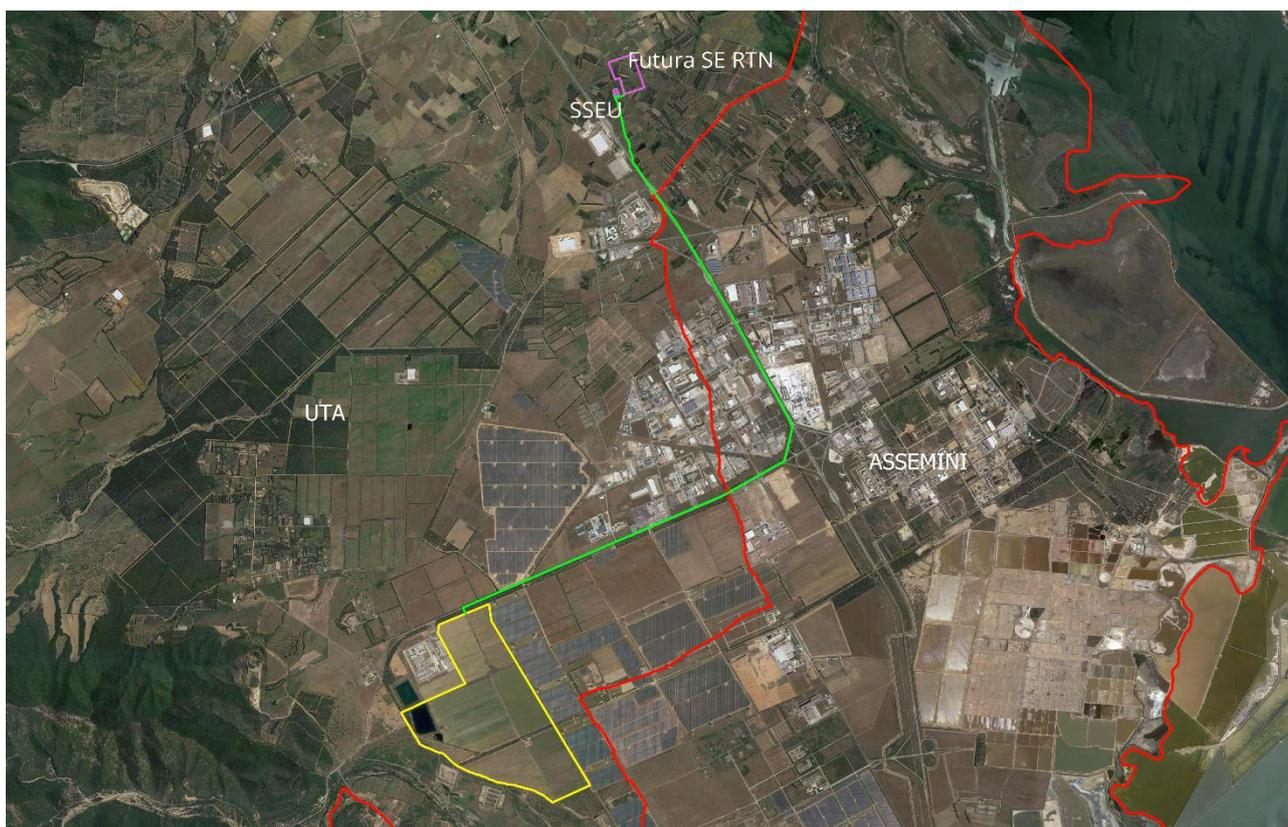
*Figura 7: area impianto (in giallo), cavidotto MT 36 kV (in verde) e aree della SSEU e della futura SE RTN (in viola); in rosso i limiti comunali*
