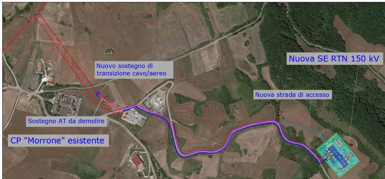
Figura 4.3.2 – Planimetria dei raccordi di collegamento alla linea esistente a 150 kV “Larino – CP Morrone”
