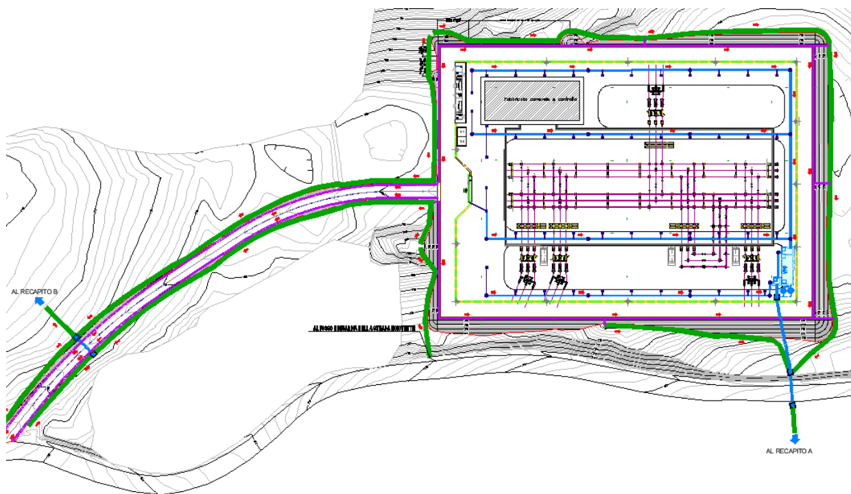
Figura 2.4.9 - Regimazione di versante e della strada di accesso
