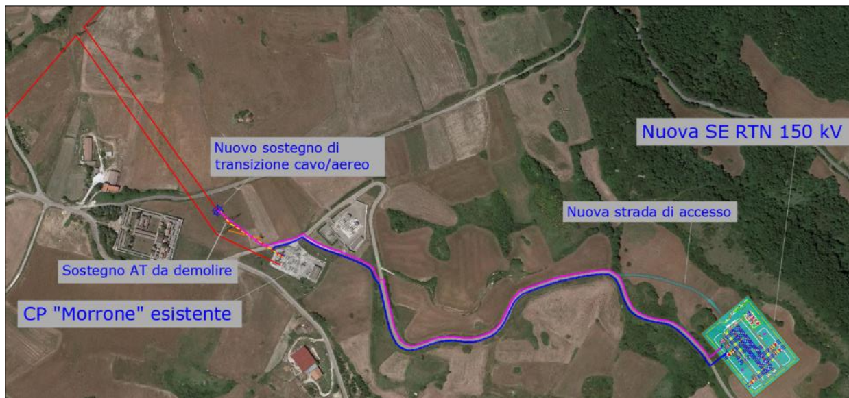
Figura 2.3.12 – Planimetria dei raccordi di collegamento alla linea esistente a 150 kV “Larino – CP Morrone”
