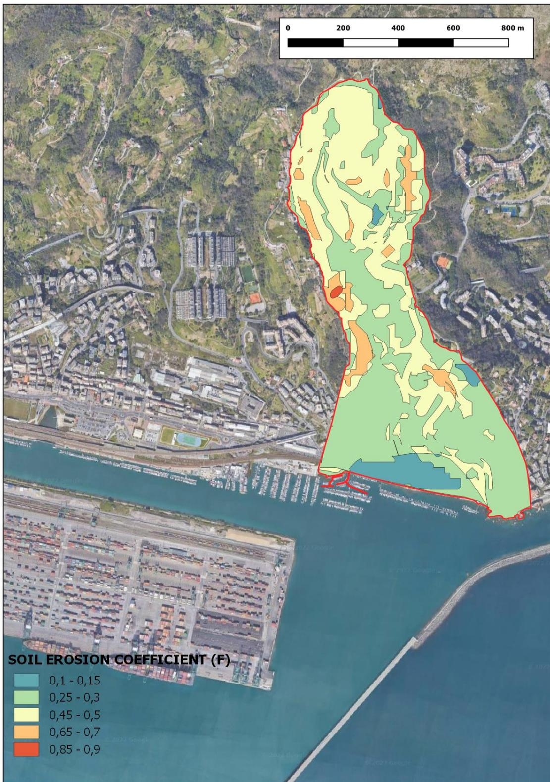
Figura 76 – Bacino del rio Grillè – EPM – Coefficiente di erosione ( $\Phi$ ) – Valori medi
