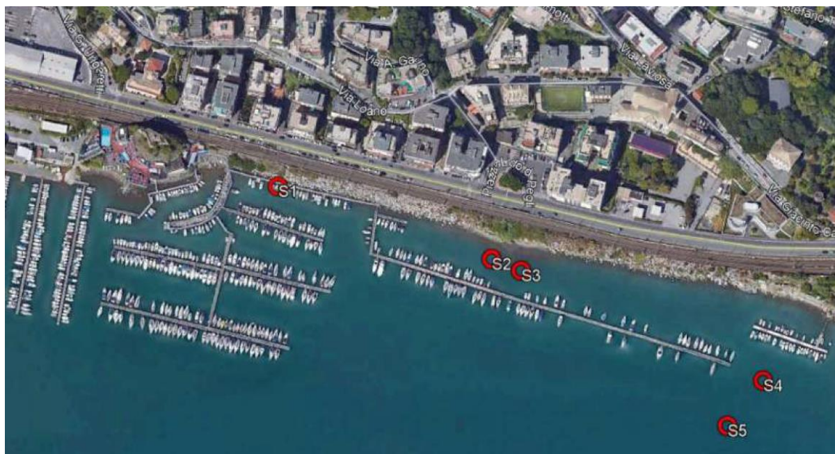
Figura 96 – Localizzazione dei sondaggi a carotaggio continuo (Relazione geologica, indagini geognostiche, Progetto Definitivo, elaborato D-DG-PRD04-0)
