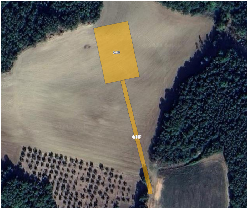
Piazzola di montaggio e pista d'accesso wtg4
