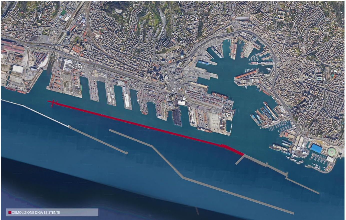
Figura 5-4: Planimetria delle demolizioni.
