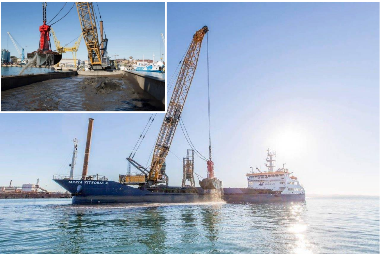
Figura 8-1: Motopontone autocaricante con benna ambientale
