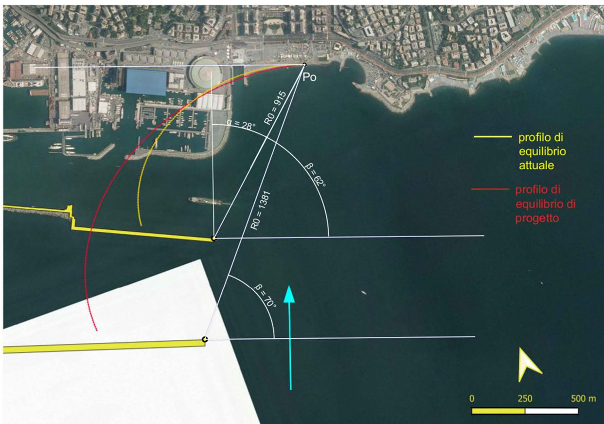
FIGURA 4-19 – TRACCIAMENTO DELLA CURVA PARAMETRICA RAPPRESENTATIVA DEL PROFILO DI EQUILIBRIO DI SILVESTER E HSU A SEGUITO DELLA REALIZZAZIONE DELLA NUOVA DIGA FORANEA PREVISTO DALLA SOLUZIONE S3.
