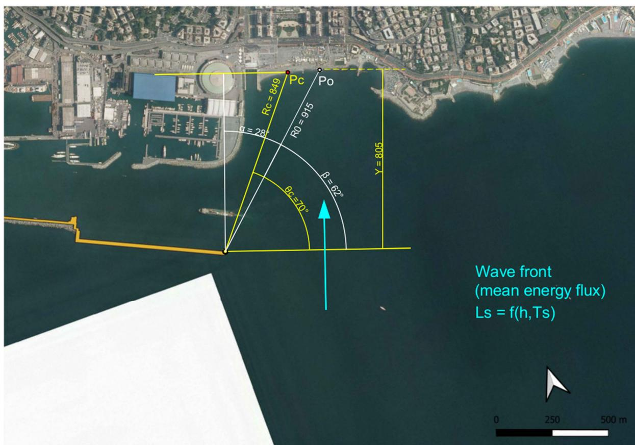
FIGURA 4-17 – DETERMINAZIONE DEI PARAMETRI DELL'EQUAZIONE DI EQUILIBRIO DEL PROFILO DI SPIAGGIA DI SILVESTER E HSU PER LA CONFIGURAZIONE ATTUALE (2010).
