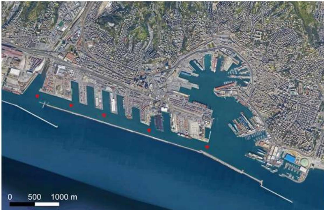
Figura 2.10: Proposta di posizionamento dei transetti (in rosso) lungo il canale di ingresso al porto
