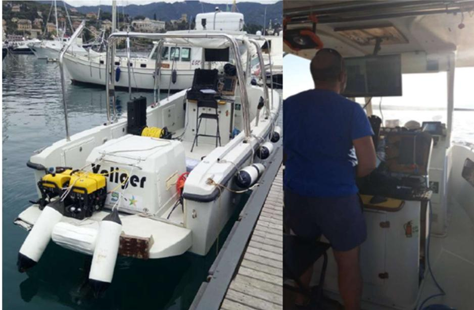
Figura 2.8: Imbarcazione R/V VELIGER configurata per rilevamenti ROV e fase di pilotaggio con operatore ROV.
