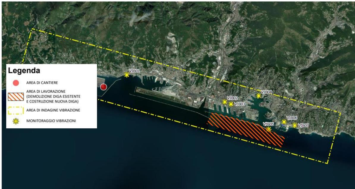
Figura 7-1: Ubicazione dei punti di monitoraggio delle vibrazioni
