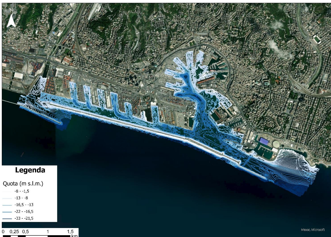
Figura 5-7: Rilievo batimetrico nell'area della diga esistente (Settembre 2023)
