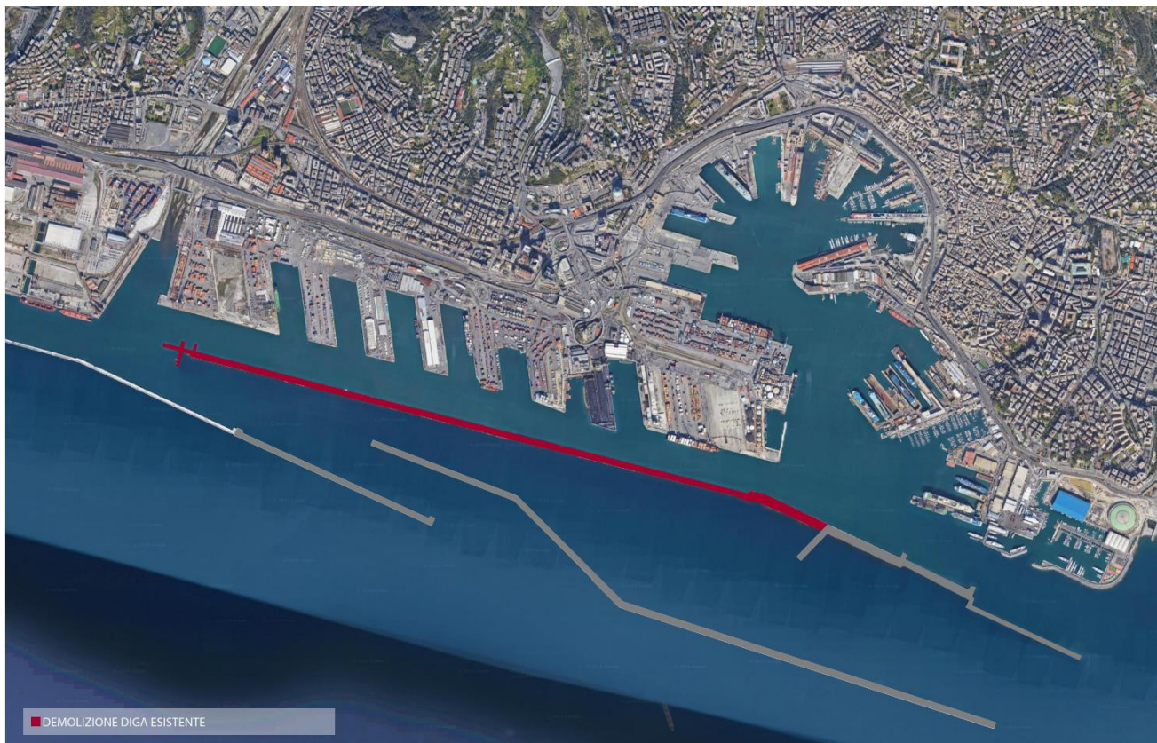
Figura 2-6: Planimetria delle demolizioni
