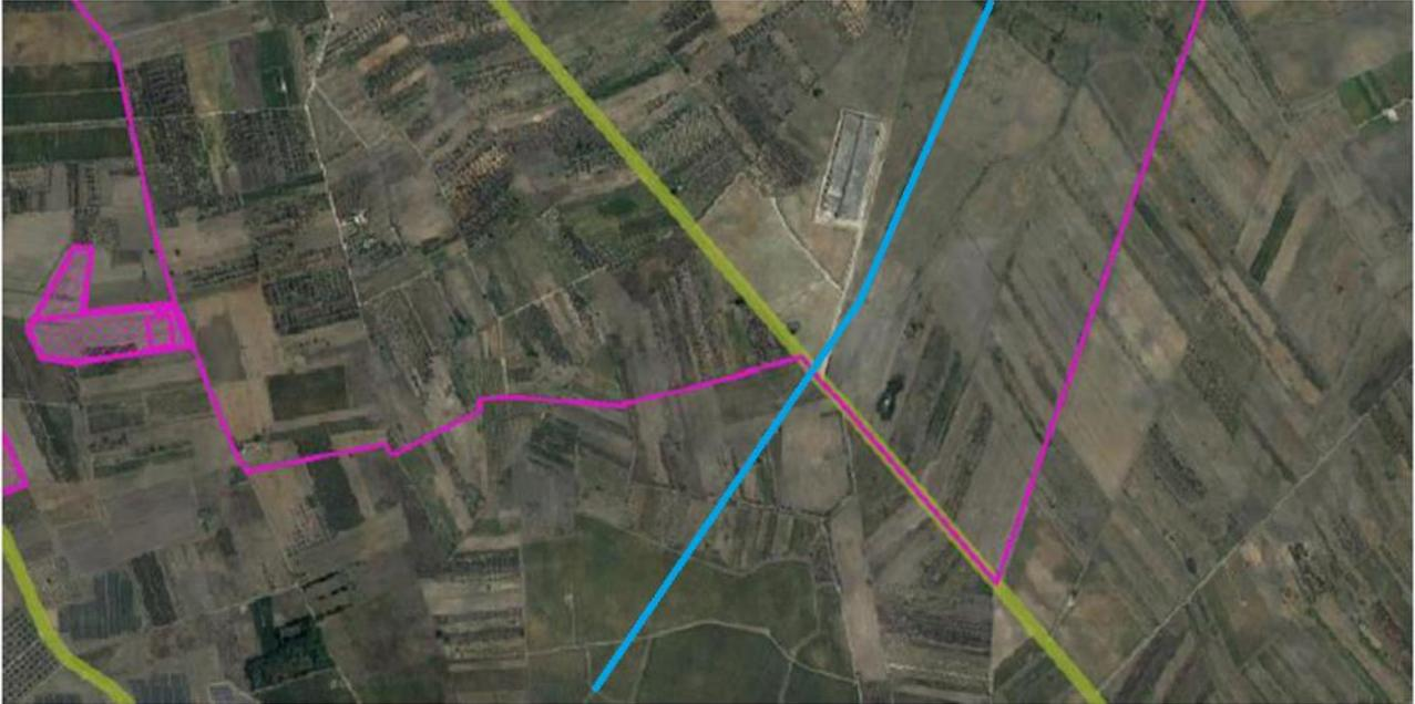
*Figura 18 – Particolare del tracciato dell'elettrodotto interrato in MT (in viola). Si può notare come la strada a valenza paesaggistica (in verde) sia già stata interessata da infrastrutture interrate, come nel caso di un tratto di condotta dell'acquedotto pugliese (in azzurro)*
