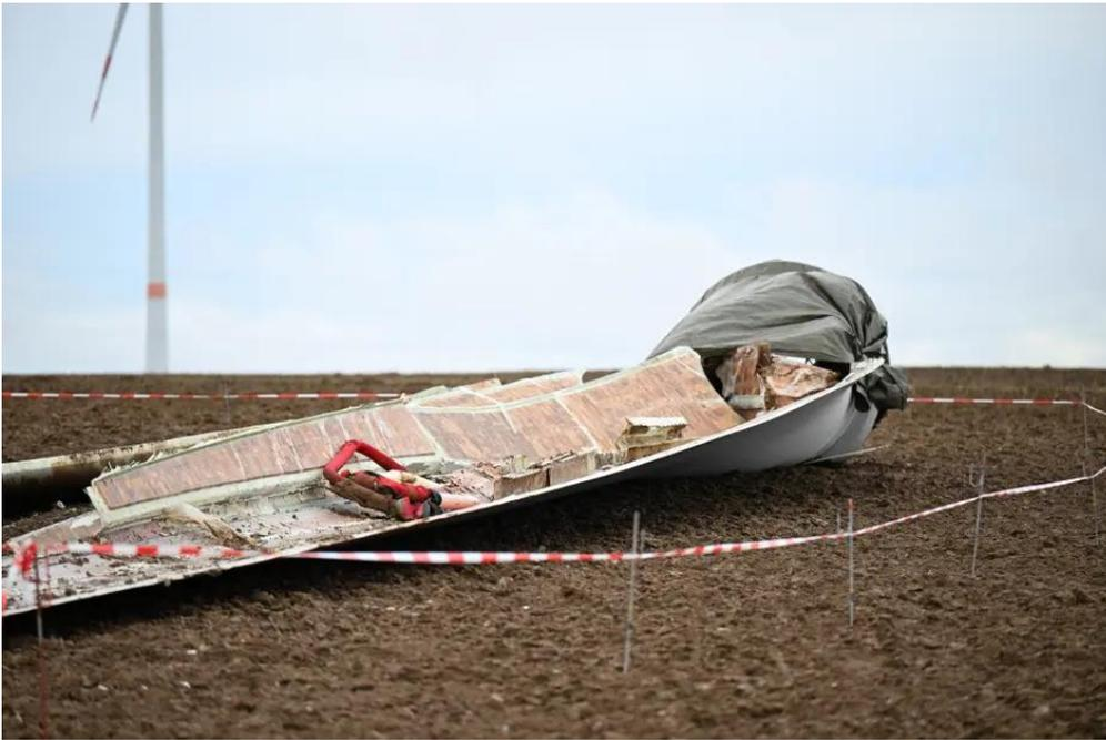
**In conclusione**, è necessario analizzare il rischio per la salute pubblica da rottura e distacco di una pala, da distacco di pezzi di una pala, da ribaltamento della turbina e da caduta della navicella con procedimenti ingegneristici aggiornati e rivalutare le posizioni degli aerogeneratori.
