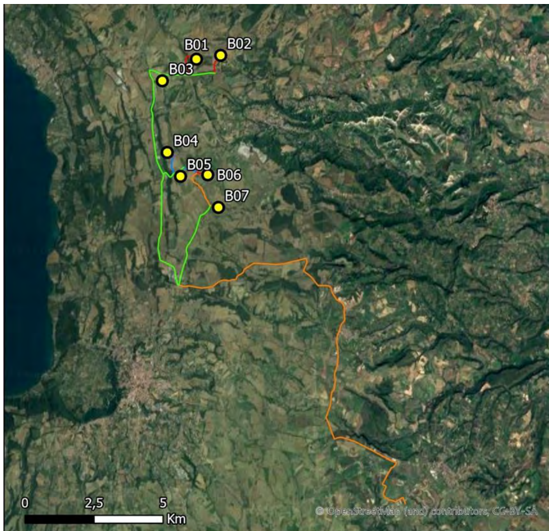
Figura 1.1: Inquadramento generale dell'area di progetto e della viabilità (rosso=pista di accesso; blu=secondaria; verde=principale) e della connessione (linea arancio)
