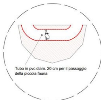
Figura 15: Esempio di realizzazione tubazioni in PVC per passaggio piccola fauna
