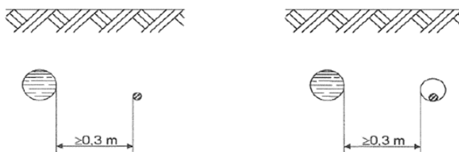
Figura 33: Parallelismo cavo elettrico – tubazioni metalliche (3)
