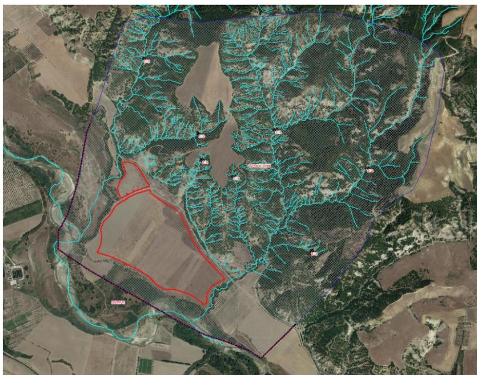
Figura 10: Geometria del dominio di calcolo dell'Area 1 (Nord) con indicazione del perimetro di impianto (in rosso) e del reticolo idrografico
