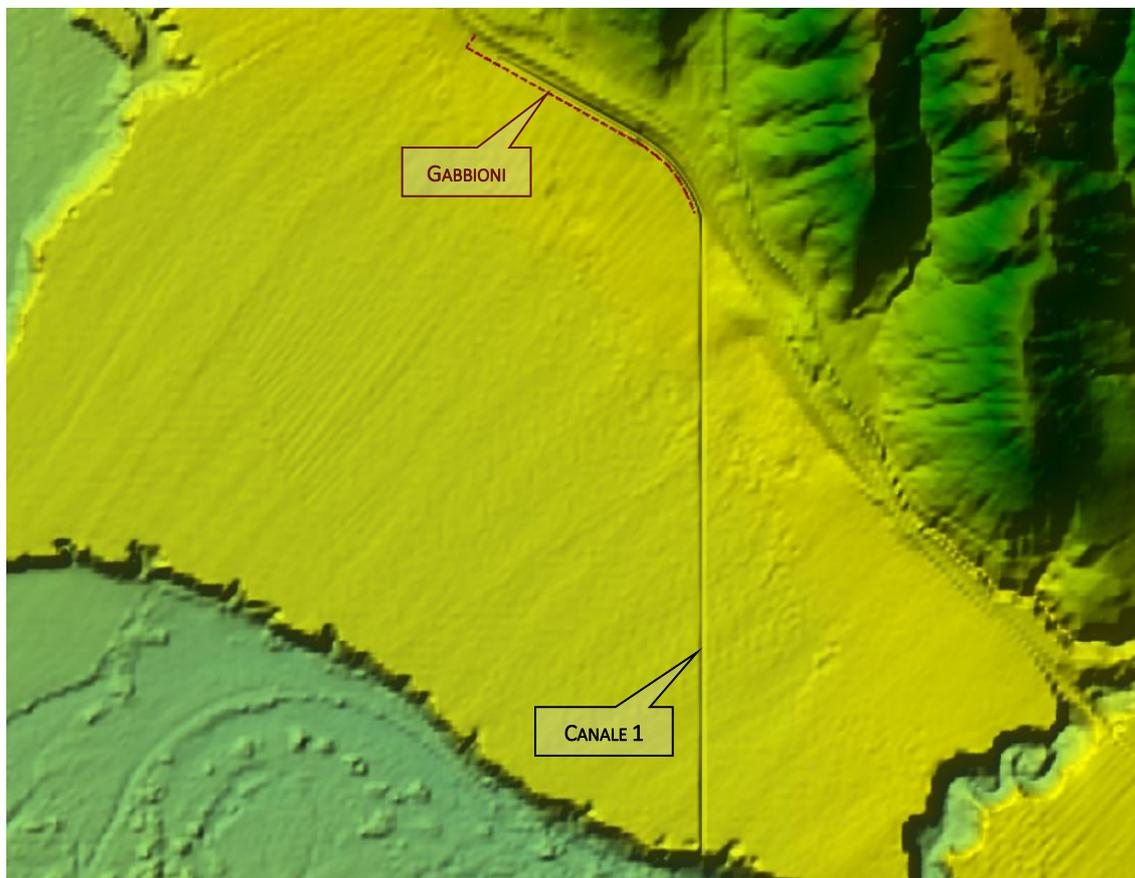
Figura 27: Stralcio del canale 1 e della gabbionata metallica previsti come opera di mitigazione nell'Area 1 – Nord
