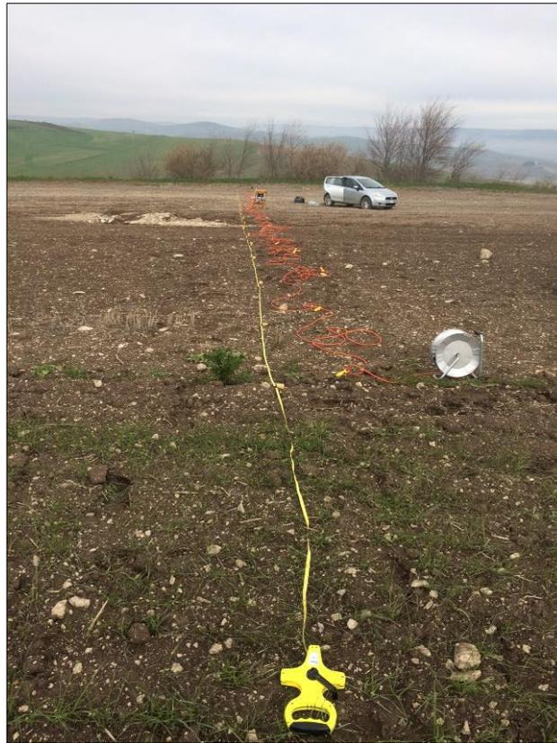
*Fig. 4 – Stendimento sismico di tipo MASW MW*
