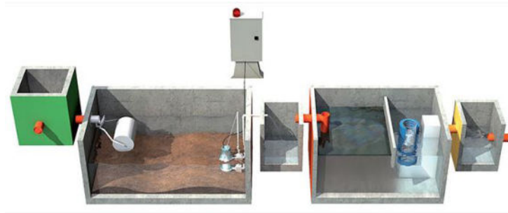
Figura 6.4 - Schema vasca di prima pioggia con sedimentatore e disoleatore.
