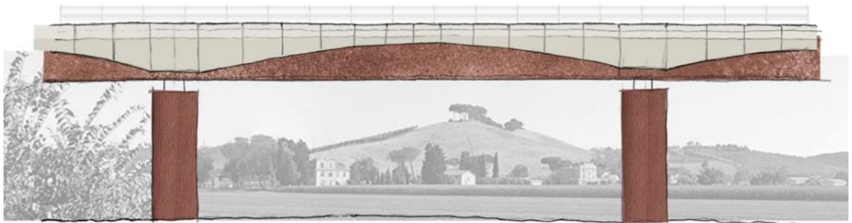
Figura 108 La forma della veletta del viadotto ricorda le formazioni collinari
