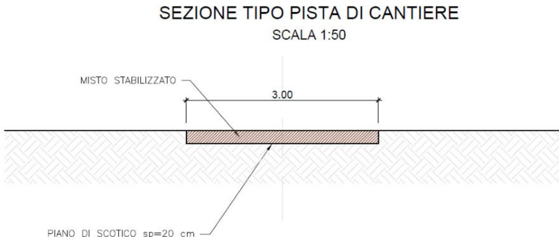
Figura 5-1 Sezione tipo pista di cantiere.
