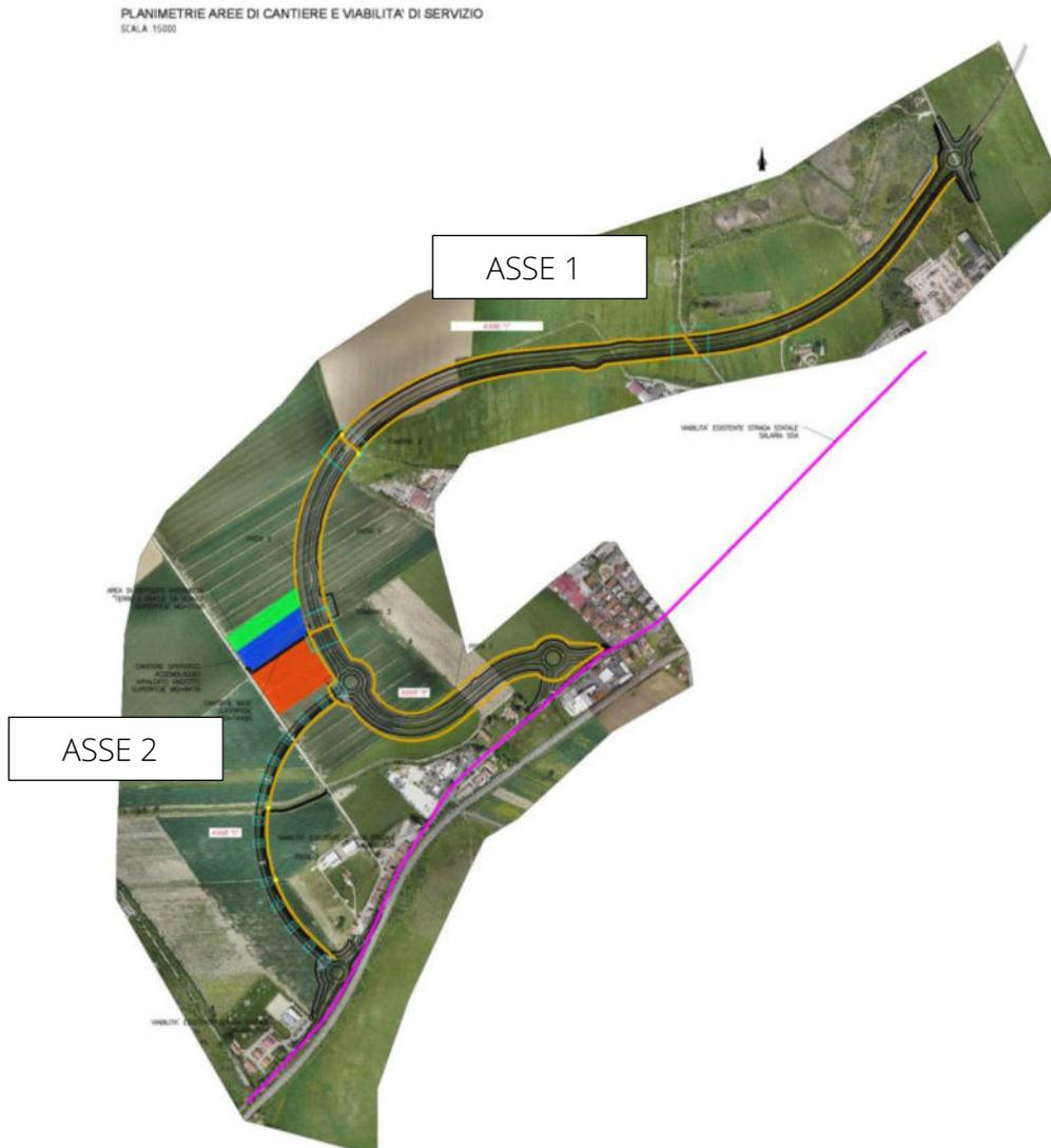
Figura 5-2 Planimetria con individuazione delle piste di cantiere (in arancione).
