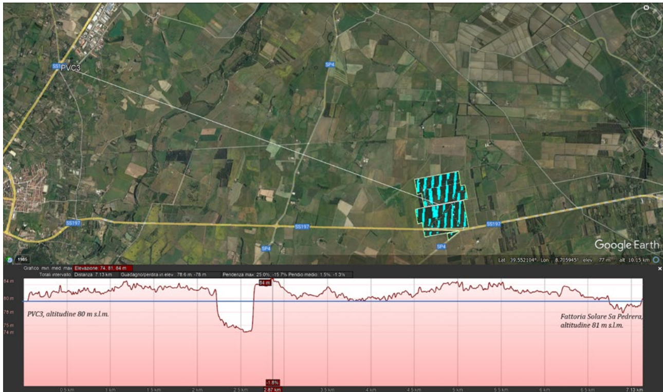
Figura 15: Profilo altimetrico della direttrice di collegamento tra il PVC3 e l'area d'impianto
