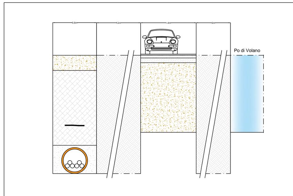
Vista A: Posa cavidotto in terreno agricolo
