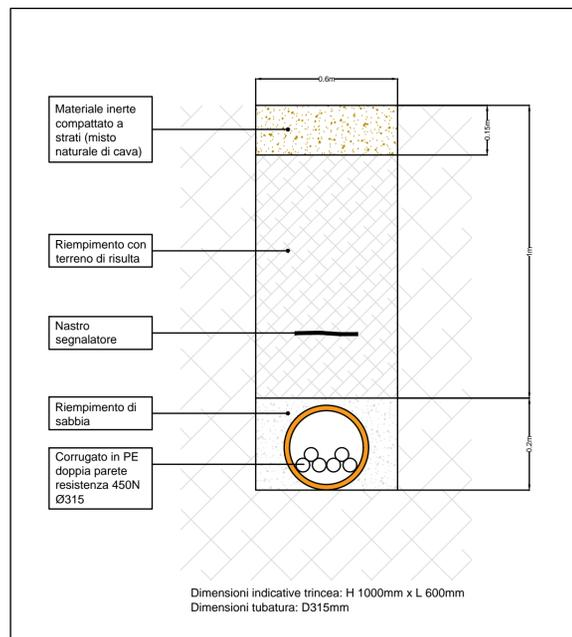
Sezione terreno agricolo e posa cavidotto
