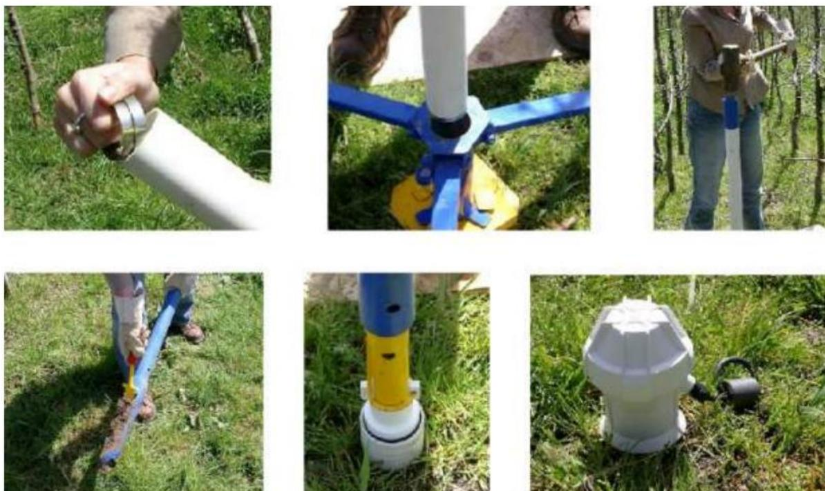
kit e procedura di installazione del sensore multi-capacitivo
