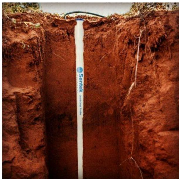
esempio di sonda multicapacitiva.
