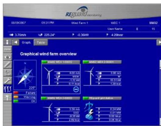
Figura 2 SCADA – Visualizzazione Stato del Parco Eolico.
