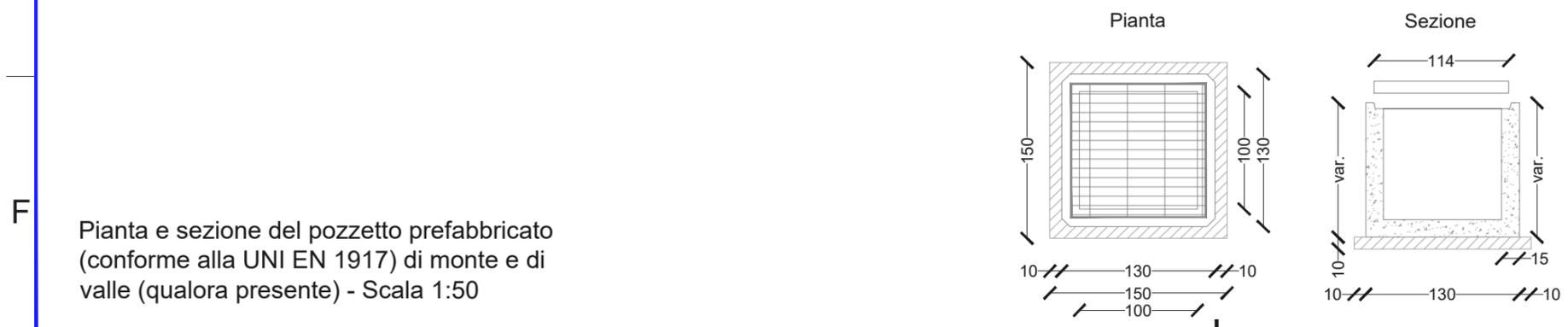
Pianta e sezione del pozzetto prefabbricato
