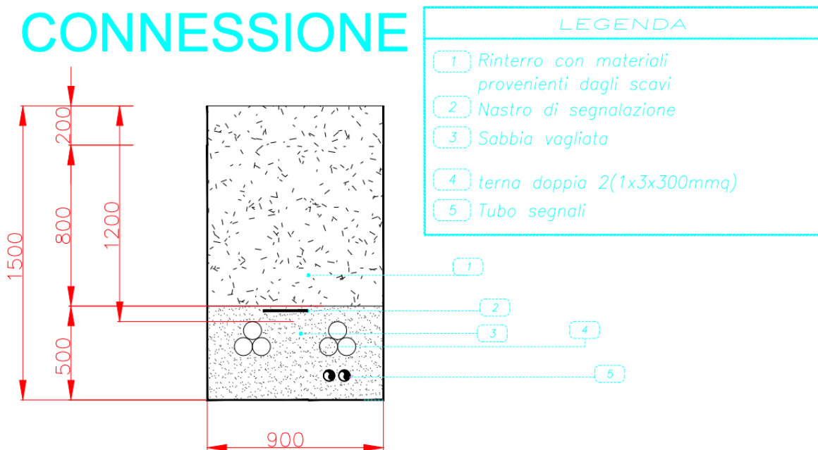
Sez Tipo AT cavidotto di connessione
