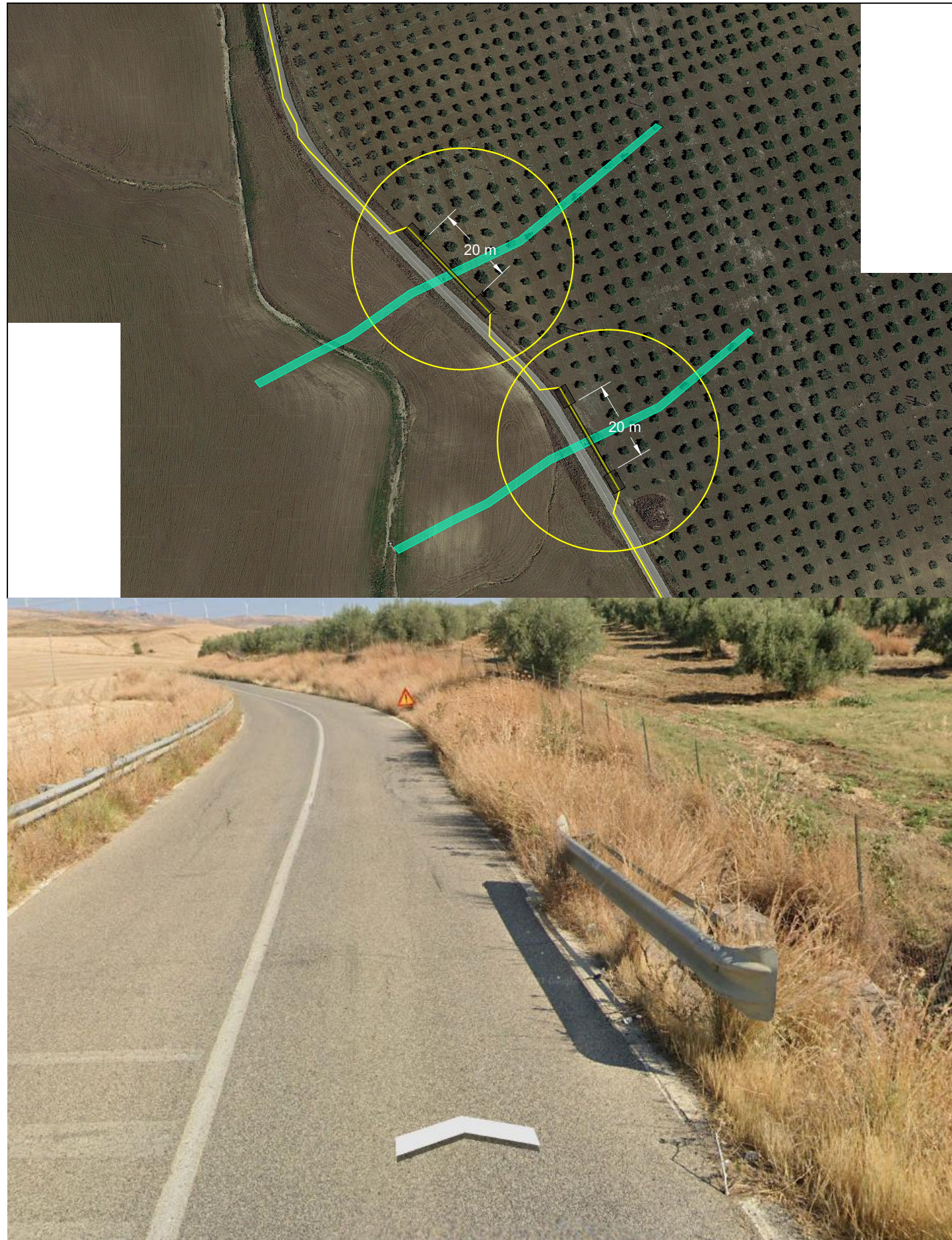
INTERF. n. 3/4 - S.P.182 - Tombino deflusso acqua Lungh. foro di trivellazione = 20 + 20 m Diametro foro = 90 cm
