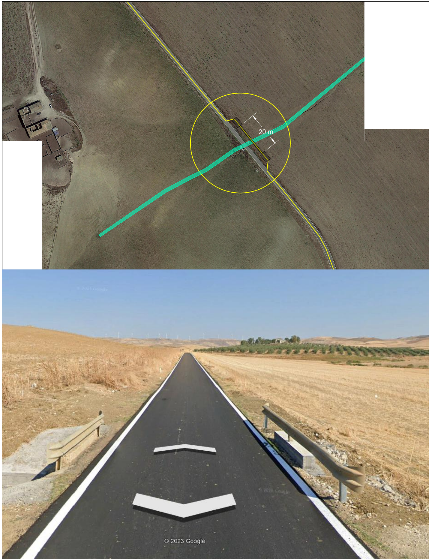
INTERF. n. 2 - S.P.182 - Tombino deflusso acqua Lungh. foro di trivellazione = 20 m Diametro foro = 90 cm
