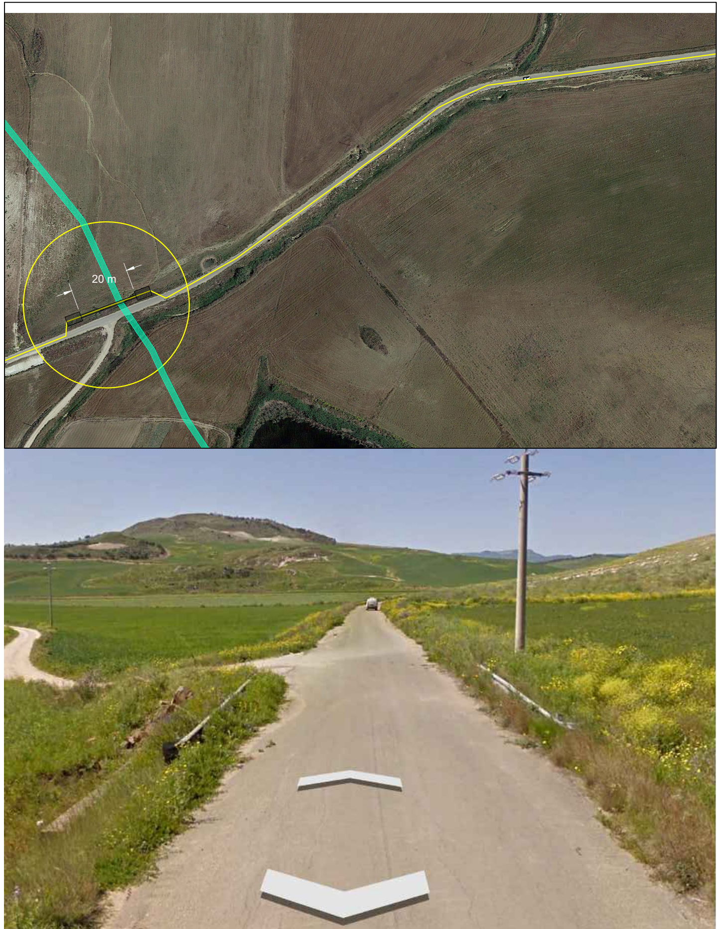
INTERF. n. 1 - Strada interpoderale - Tombino deflusso acqua Lungh. foro di trivellazione = 20 m Diametro foro = 90 cm
