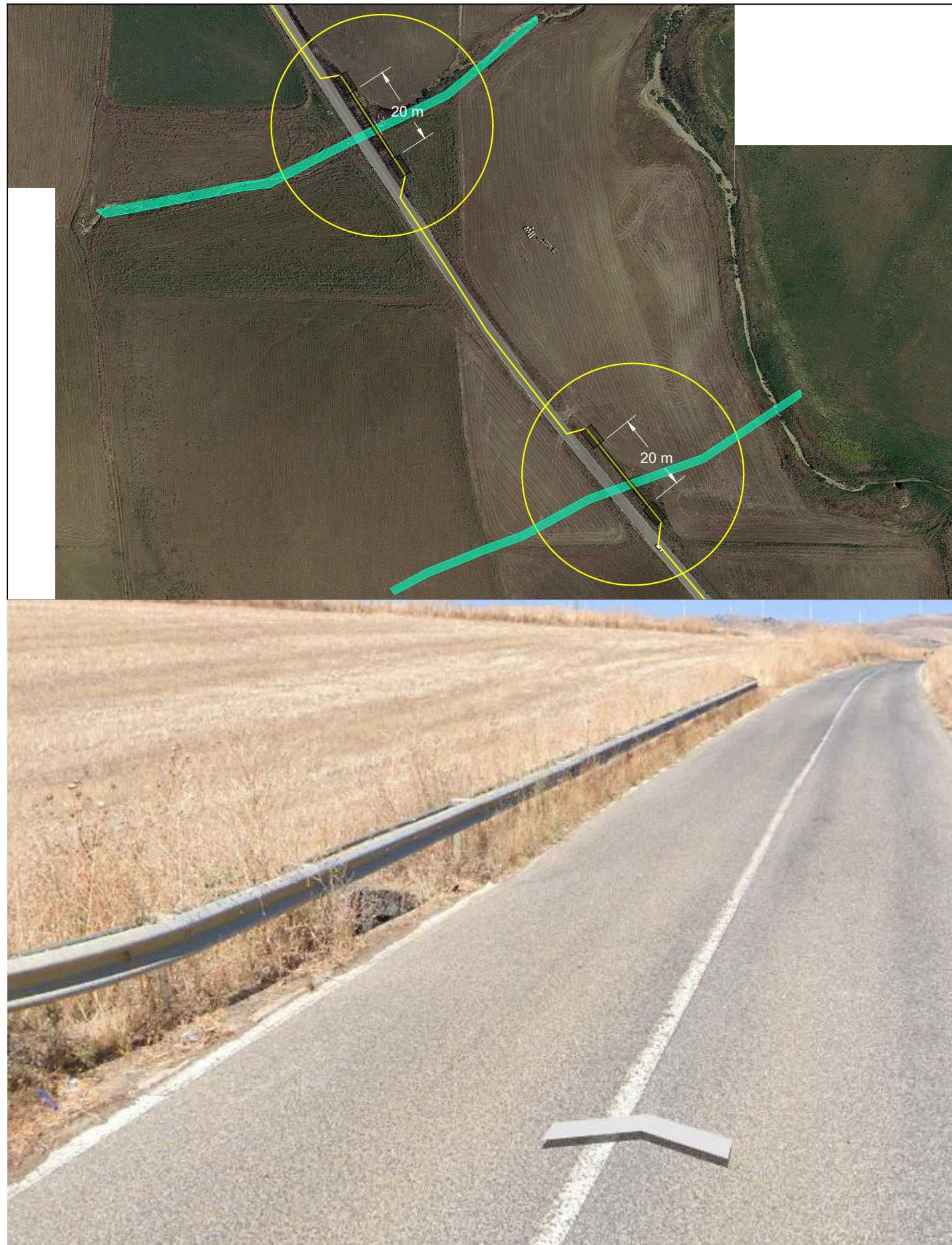
INTERF. n. 8/9 - S.P.182 - Tombino deflusso acqua Lungh. foro di trivellazione = 20 + 20 m Diametro foro = 90 cm
