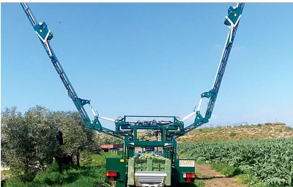
Figura 8-11. Carro agevolatore per la raccolta ortaggi
