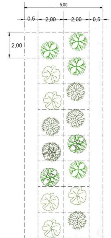
Figura 7-8 sezione tipo e sesto d'impianto della siepe perimetrale
