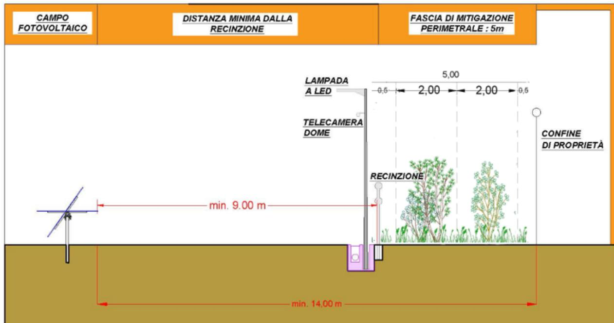
Figura 4-1. Sezione tipo della siepe perimetrale
