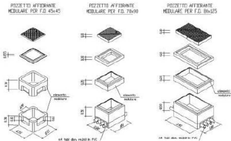
Figura 6 - Tipologia pozzetti
