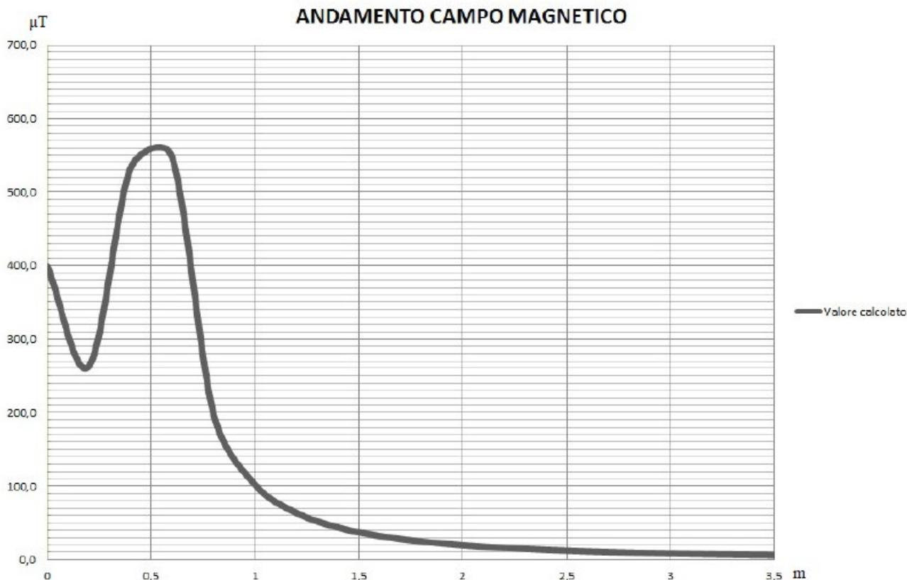
Figura 72 - Valore dell'induzione magnetica al suolo del cavidotto MT
