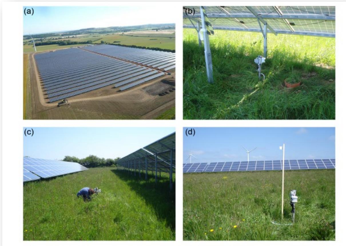
**Figura 41 - (a) foto aerea del Westmill Solar Park; (b) Under: punto di rilevamento sotto i moduli; (c); Gap: punto di rilevamento tra i filari di moduli; (d) Control: punto di rilevamento esterno**
