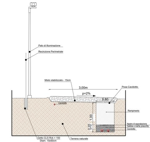
SEZIONE TIPO STRADA PERIMETRALE CON PARTICOLARE POZZETTO
