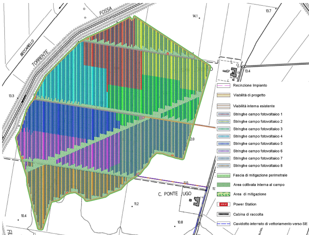
Figura 2 - Dettaglio suddivisione in sottocampi (cfr. elaborato PRO_TAV_10)
