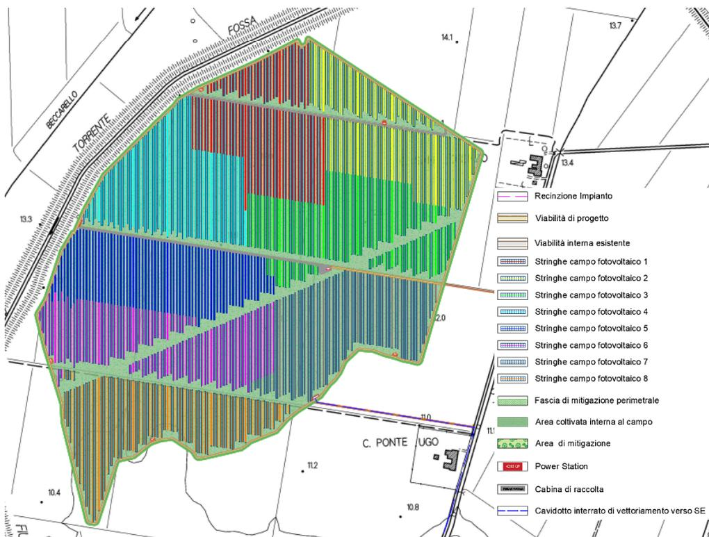
Figura 2 - Dettaglio suddivisione in sottocampi (PRO\_TAV\_10)
