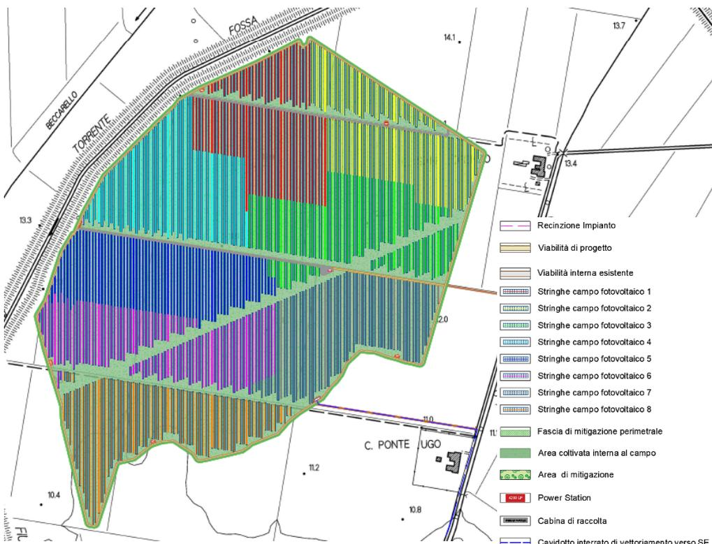
Figura 2 - Dettaglio suddivisione in sottocampi (cfr. elaborato PRO\_TAV\_10)
