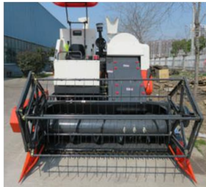
Figura 50 - Esempio di minitrebbia: la larghezza di lavoro risulta perfettamente adattabile al contesto in cui si opera
