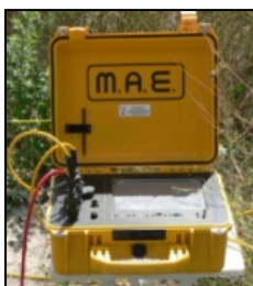
Fig. 2: sismografo multicanale M.A.E. modello A 6000 S.
