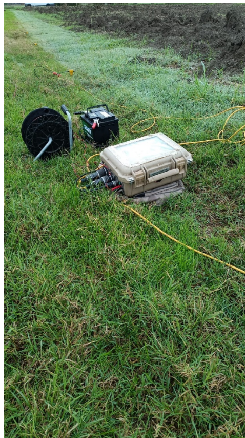
FOTO 2A: postazione di energizzazione SS2
