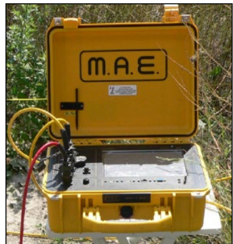
Fig. 3: sismografo multicanale M.A.E. modello A 6000 S.
