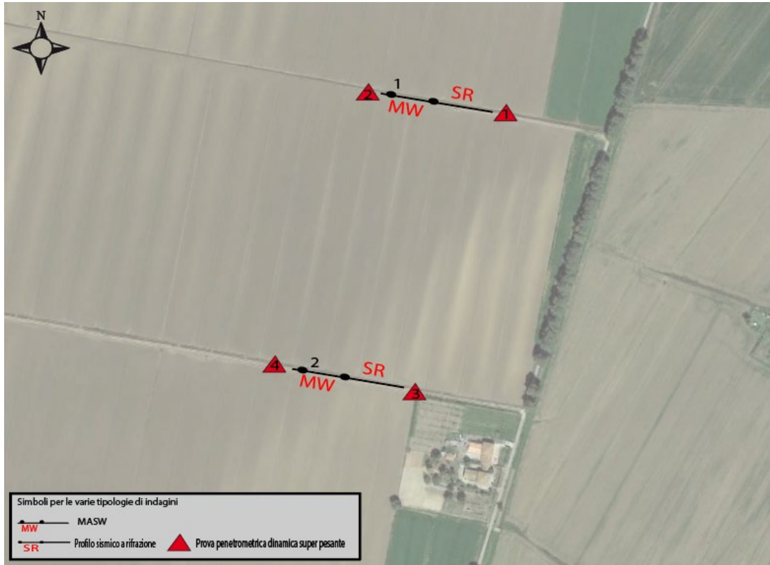
Fig. 4: ubicazione dei profili sismici.
