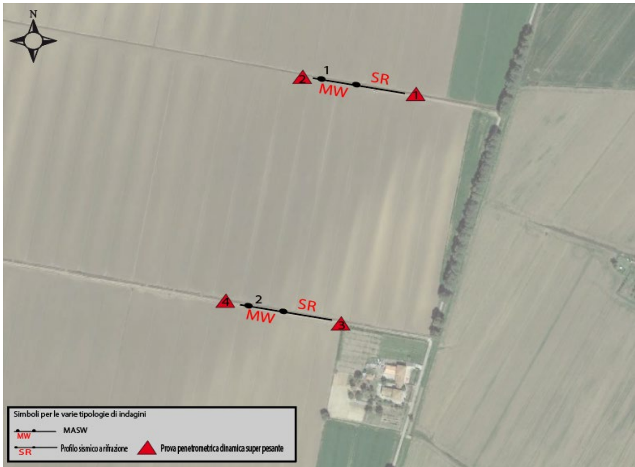
Fig. 1: Ubicazione delle indagini geotecniche e geofisiche eseguite.
