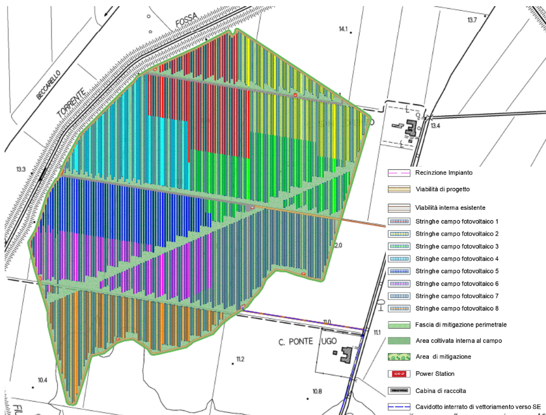
Figura 3 - Dettaglio suddivisione in sottocampi (PRO_TAV_10)
