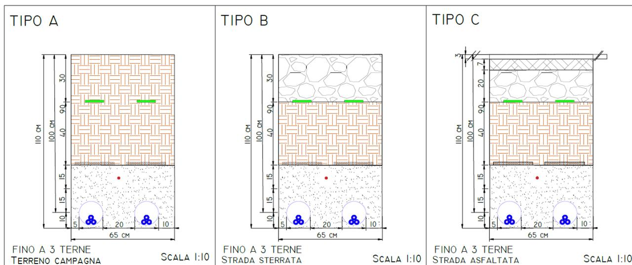
**Figura 22 - TIPOLOGIE SEZIONI DI SCAVO LINEE MT ESTERNE ALL'IMPIANTO**
