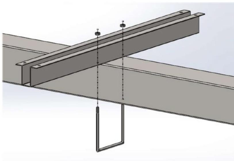
**Figura 16 Particolare dell'installazione Omega**
