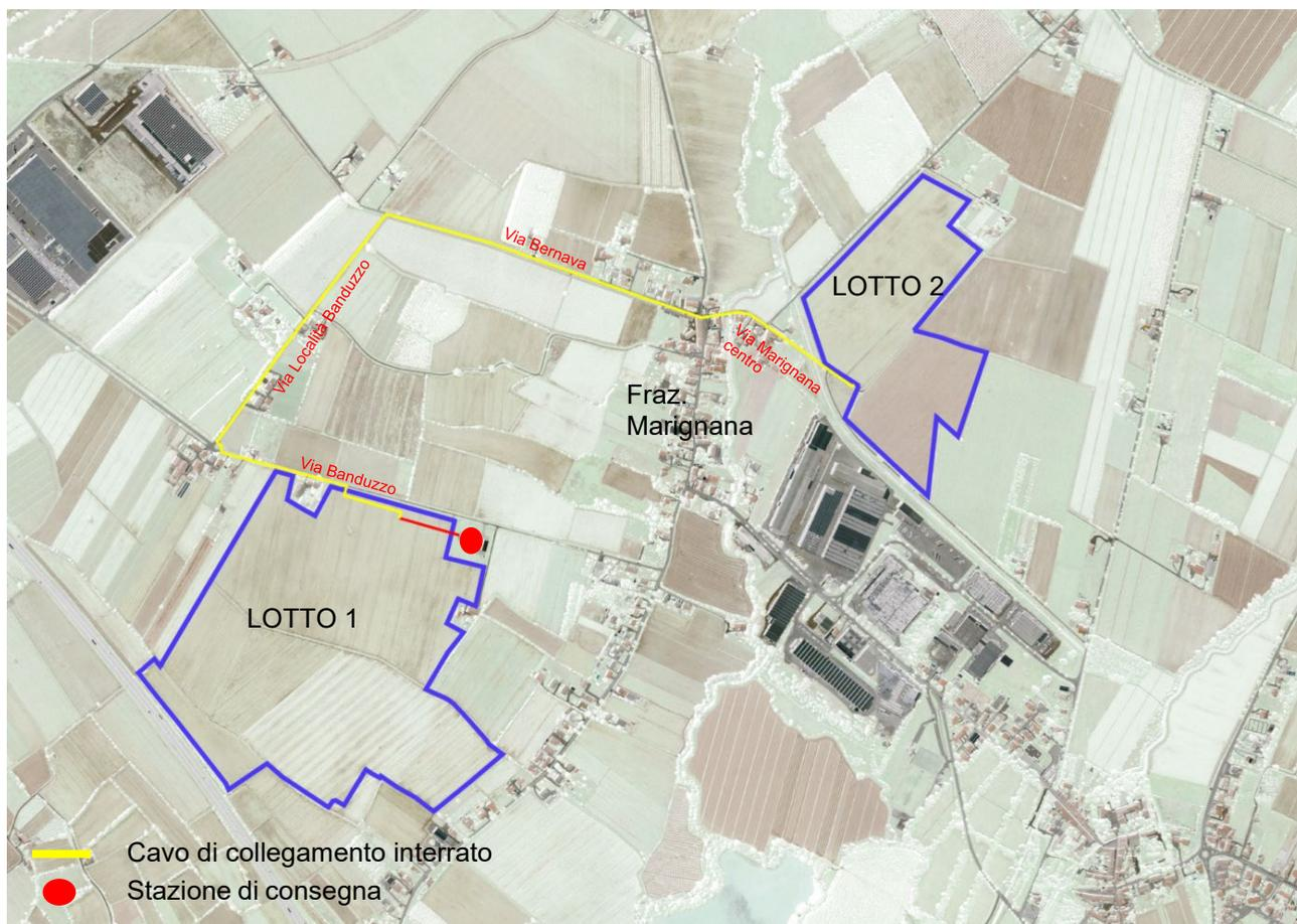
**Figura 21 Inquadramento progetto su ortofoto con collegamento tra i due lotti (in giallo) e collegamento alla CP di e-distribuzione (in rosso)**
