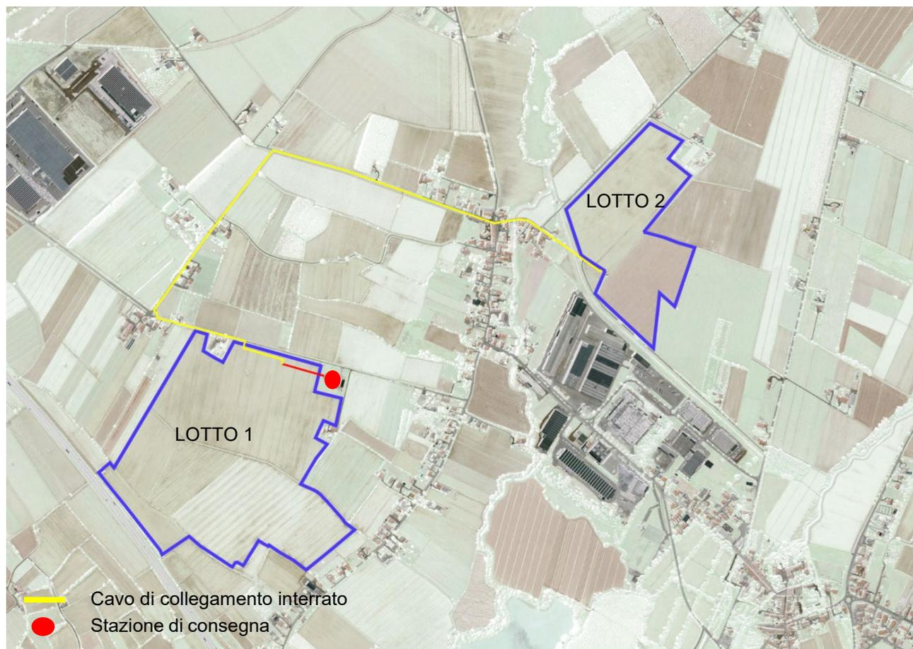
**Figura 2 Inquadramento progetto su ortofoto con collegamento tra i due lotti (in giallo) e collegamento alla CP di e-distribuzione (in rosso)**
