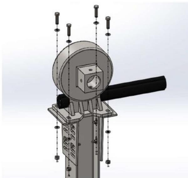
**Figura 15 Particolare installazione del motore**
