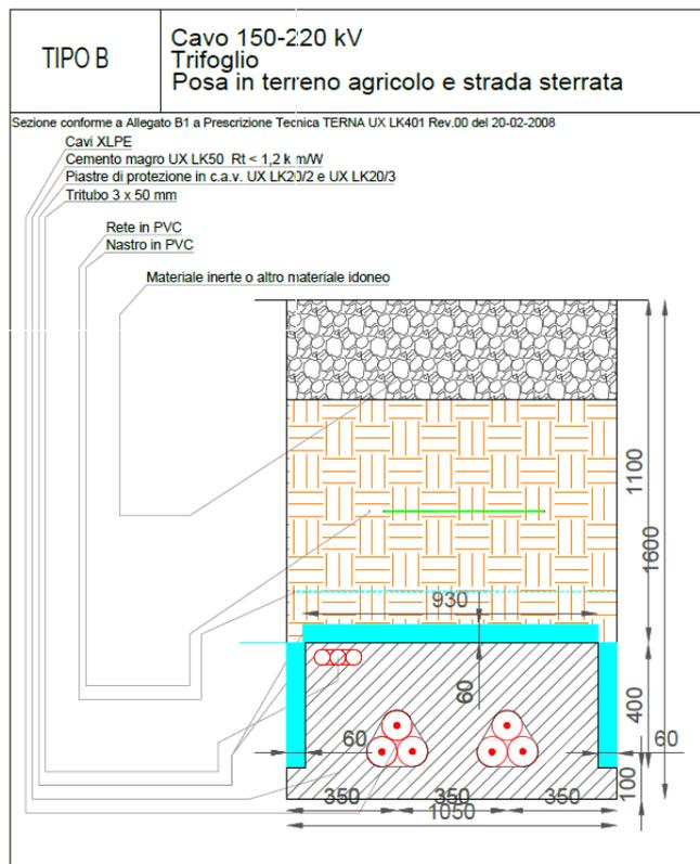
Figura 23 tipologie sezioni di scavo linee AT interne all'impianto
