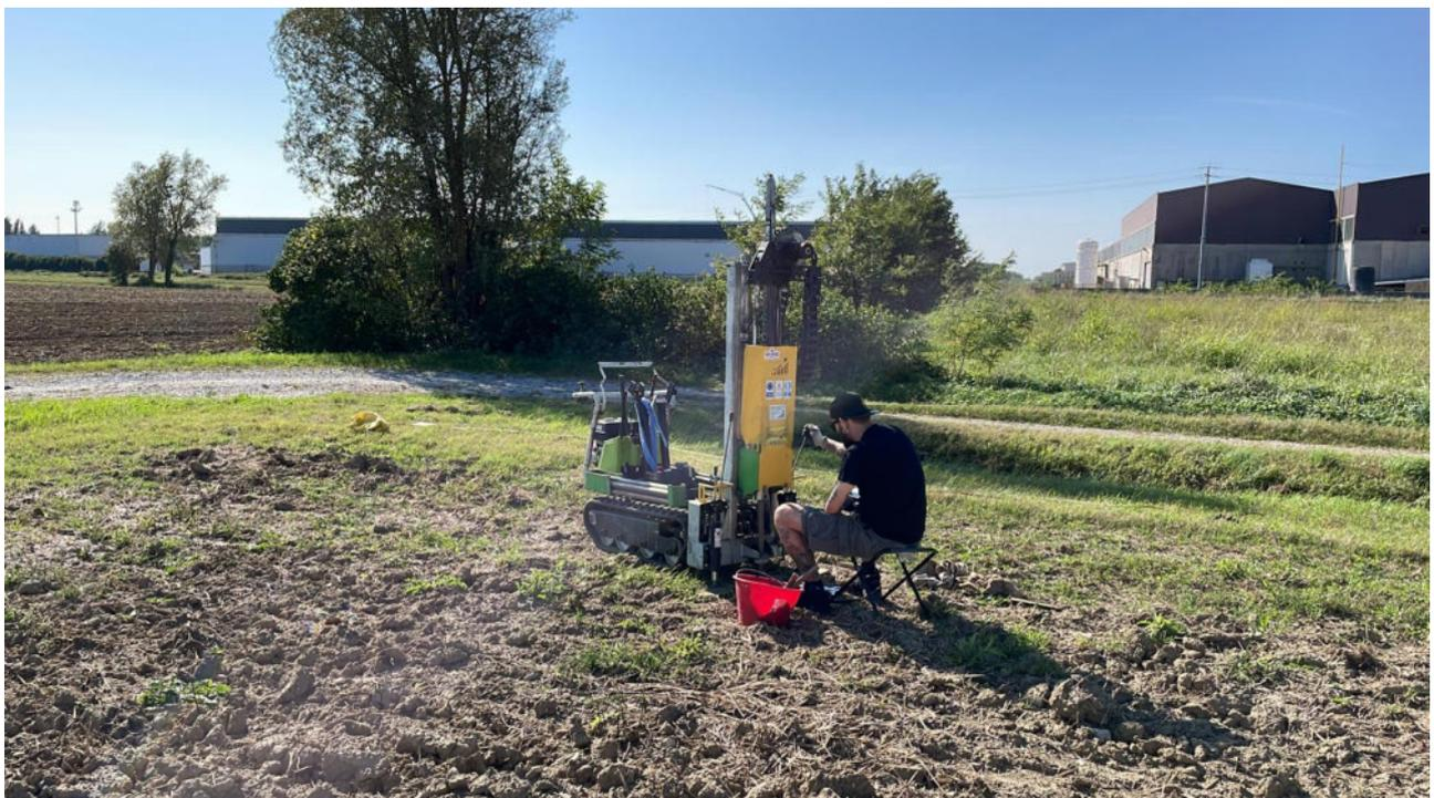
**Fig.1 - Prova Penetrometrica Dinamica DPSH 1**
