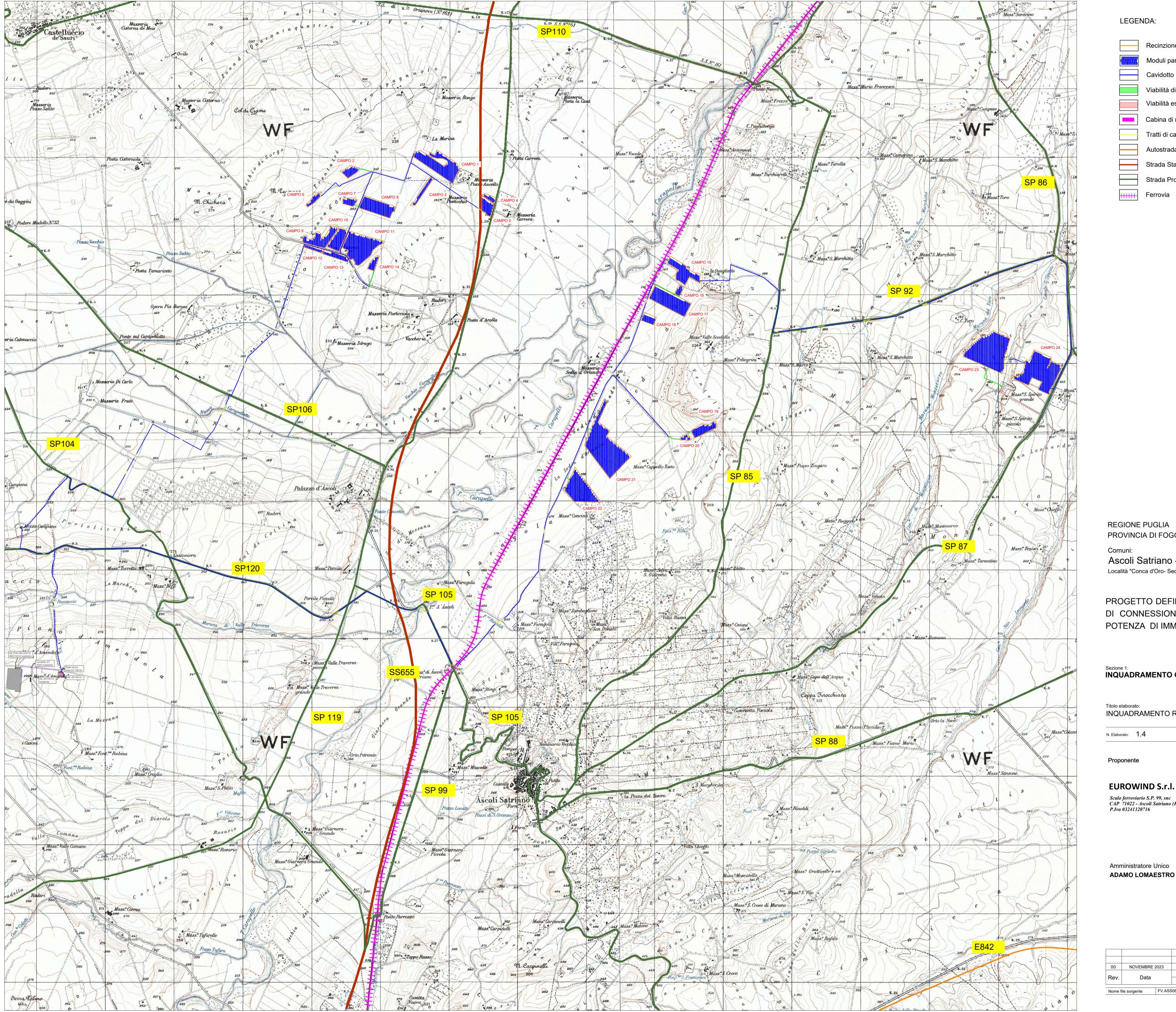
Recinzione Moduli pannelli fotovoltaici Cavidotto MT interrato esterno ai campi
