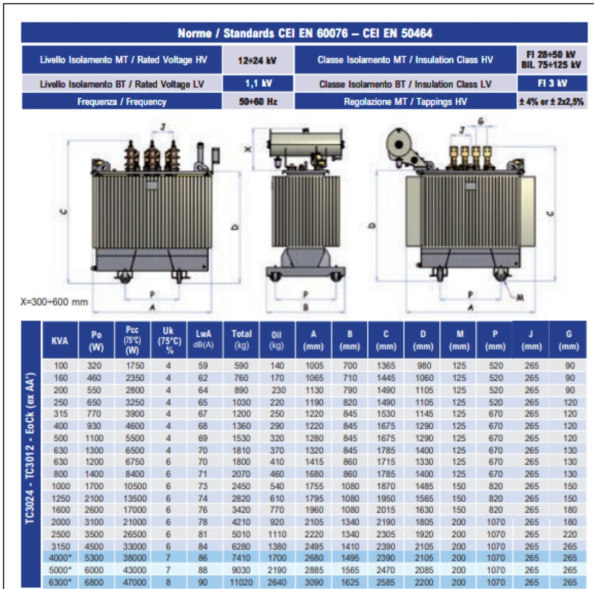
Figura 10: Scheda Tecnica di trasformatori aventi caratteristiche compatibili con i modelli di trasformatore previsti per l'impianto FV di progetto.
