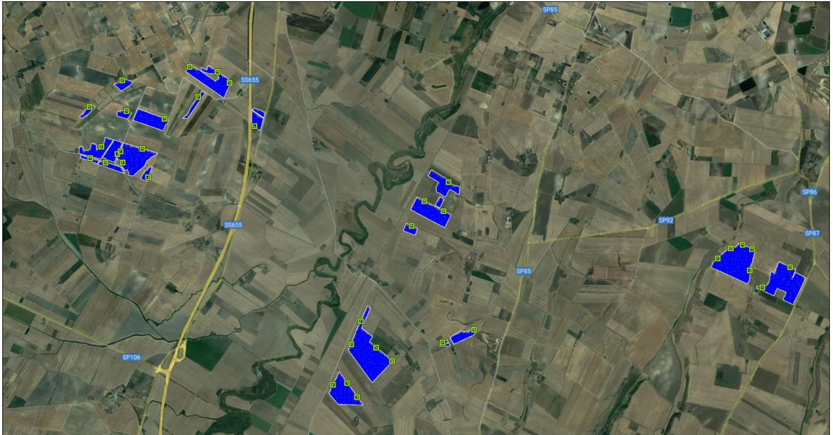
Figura 6: Inquadramento territoriale su ortofoto estratta da Google Earth dell'area di installazione dei moduli (perimetro di colore bianco), con evidenza delle pannellature (in blu) e delle cabine di campo (quadrati in verde) che ospiteranno inverter e trasformatori.
