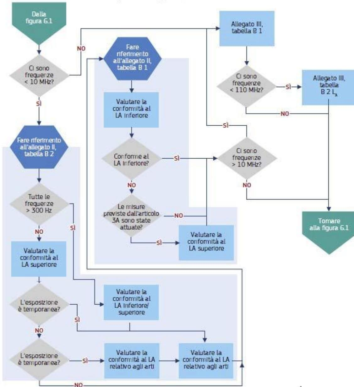
Se l'intensità dei campi elettrici non supera il LA inferiore, nessuno dei VLE applicabili verrà superato. Tuttavia, se l'intensità di campo elettrico supera il LA inferiore, la conformità al LA superiore non sarà di per sé sufficiente a evitare le fastidiose scariche di scintille. In questa situazione pertanto è necessario adottare ulteriori misure tecniche, organizzative, e se opportuno, di protezione individuale per limitare le scariche di scintille.
