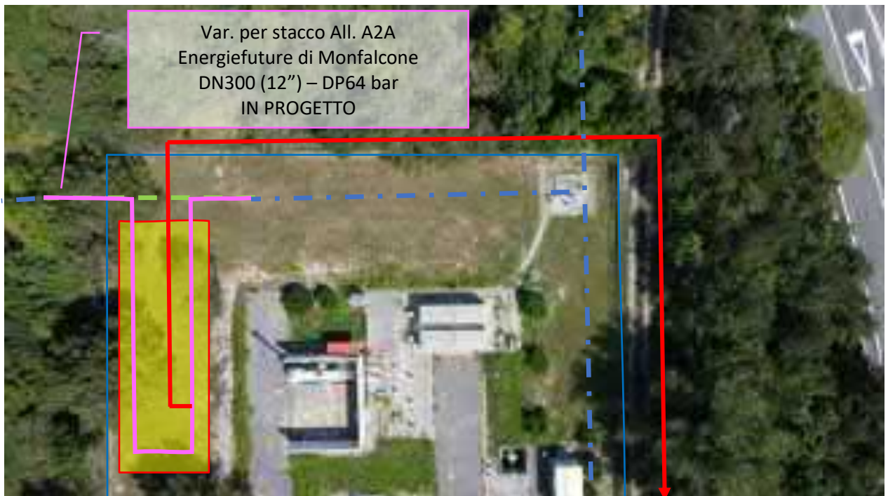
FOTO N.1a – Vista ortofoto Area di Stacco impianto PIDI n.1 all'interno dell'esistente impianto cabina n.906/A in comune di Monfalcone
