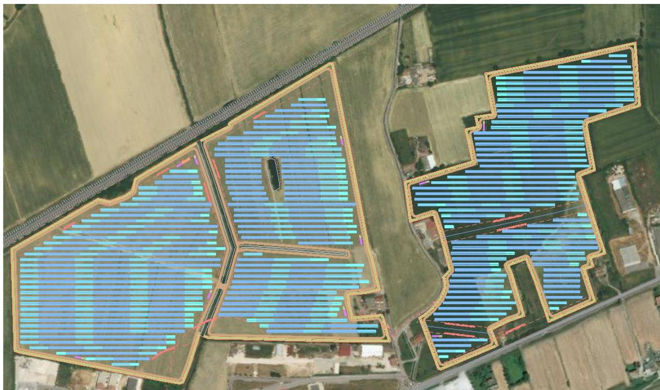
I moduli fotovoltaici impiegati sono del tipo monocristallino bifacciale con potenza nominale di 580 Watt/cad disposti su sistemi fissi di supporto, con esposizione verso Sud ed inclinazione di circa 22°.
