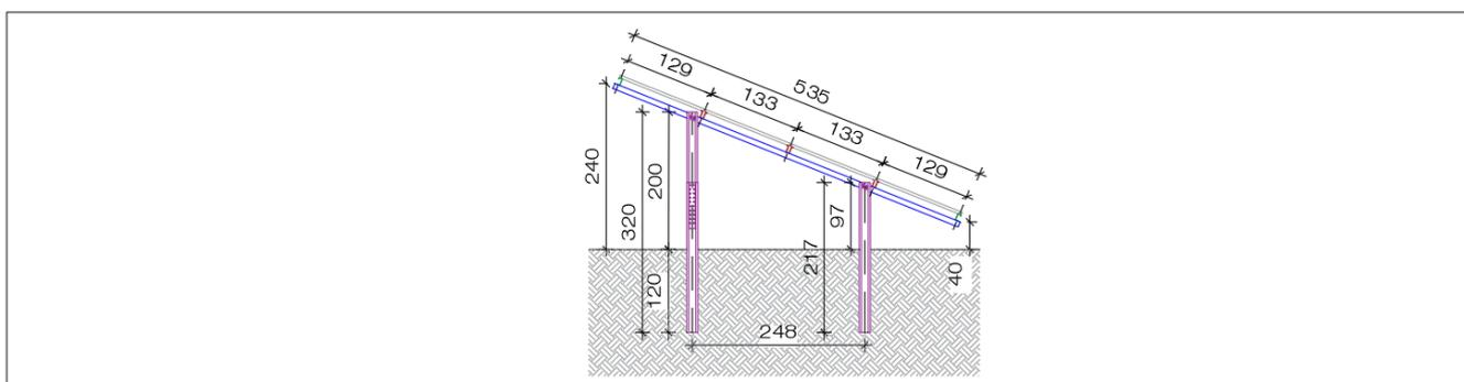
Vista laterale strutture - Modulo 8x4
