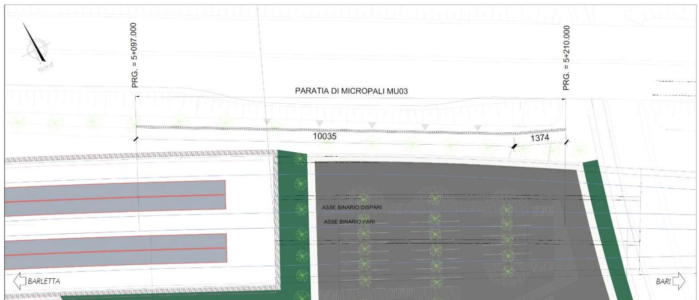
Figura 37: Planimetria particolare MU03 Paratia di protezione della viabilità SS16
