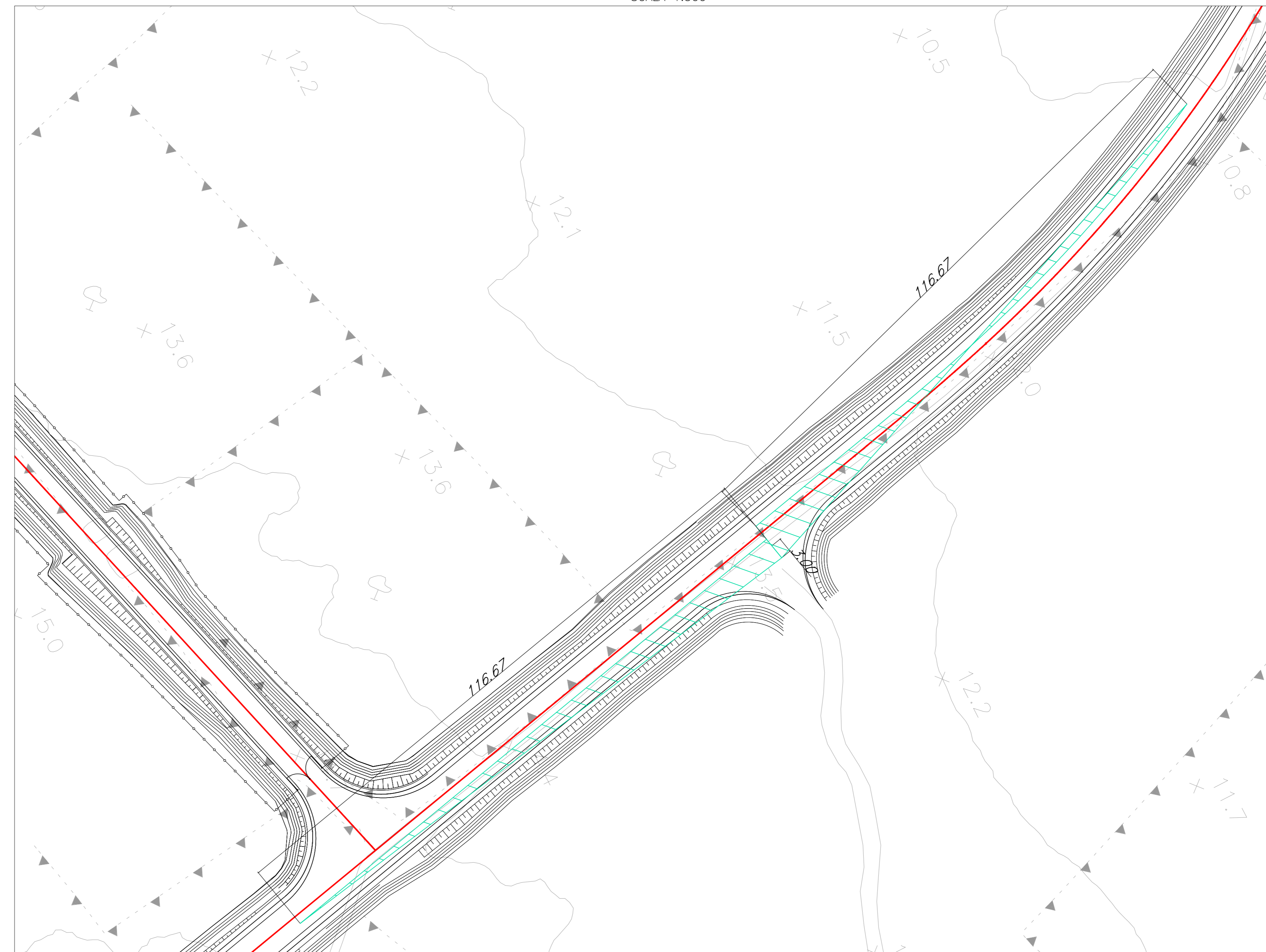
Intersezione a progressiva 0+200.00 Triangoli di visibilita' SCALA 1:500
